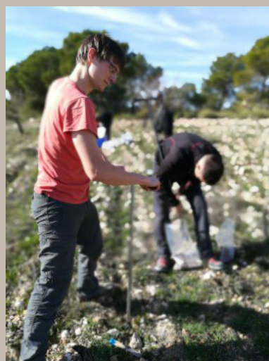
Foto 4. Muestreo de suelo con barrena a dos profundidades (0-10 cm y 10-30 cm) en el caso de estudio a largo plazo de almendro en secano considerando diferentes prácticas agrícolas (Imagen: Virginia Sánchez-Navarro, CEBAS-CSIC).
