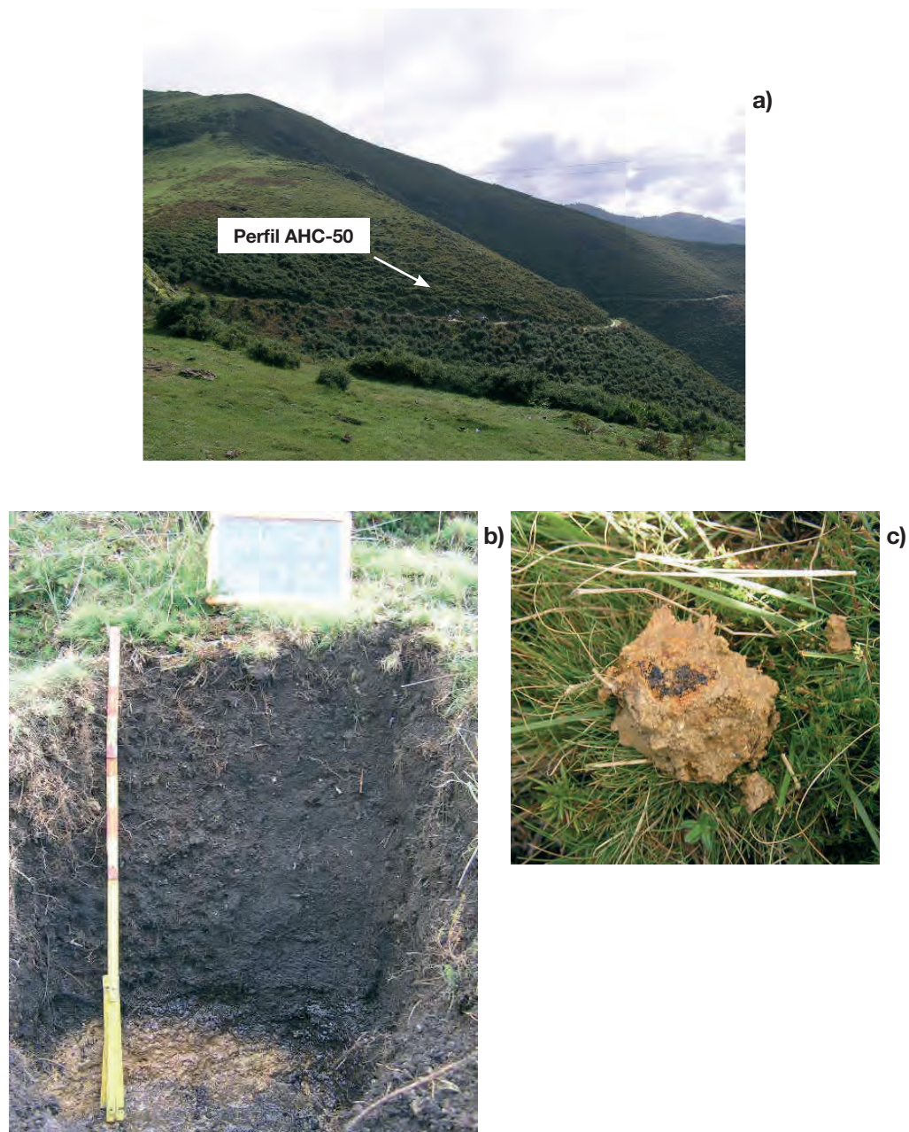
Fig. 47. (a) Localización del perfil AHC-50, (b) perfil AHC-50, (c) detalle de los precipitados formados en el horizonte C.
