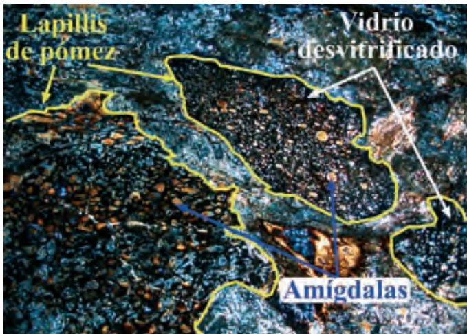
Fig. 42. Roca piroclástica con textura volcanoclástica, formada por fragmentos principalmente de tamaño lapilli, en general menores de 1.5 cm. Está esencialmente compuesta por fragmentos vítreos muy vesiculares (pómez). Los clastos presentan en ocasiones microfenocristales y microlitos de feldespato alcalino Na y K. El vidrio se encuentra reemplazado por filosilicatos, opacos y feldespatos o es criptocristalino. Las amígdalas están ocupadas esencialmente por cloritas. Los clastos están cementados por feldespato, epidota, carbonato y clorita. Toba de lapilli vítreo (según clasificación IUGS, 2002). Material de partida de Karakate 3.
