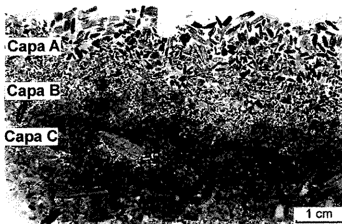
Figura 13.- Fotografía de un corte de una lámina delgada del suelo en la que se observa la diferenciación textural que ha originado la costra filtrante: capas A (gravilla) y B (arena gruesa), en las que se han lavado los elementos finos, capa C (arena muy fina y limo), de acumulación.
