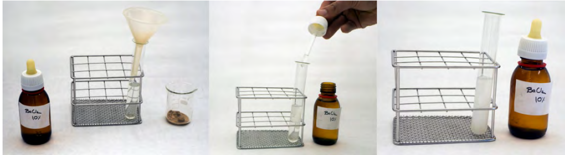
Figura 14. Una vez filtrado el extracto del suelo (izquierda), se le añaden unas gotas de la disolución de \text{BaCl}_2 10%, que en caso de haber sulfatos desencadena la formación y precipitación de \text{BaSO}_4 , apreciable por la aparición de turbidez blanquecina.
