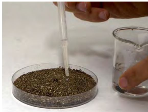
Figura 18. La deposición de la gota de agua encima del suelo debe efectuarse desde poca altura, para evitar que ésta se rompa con el impacto.
