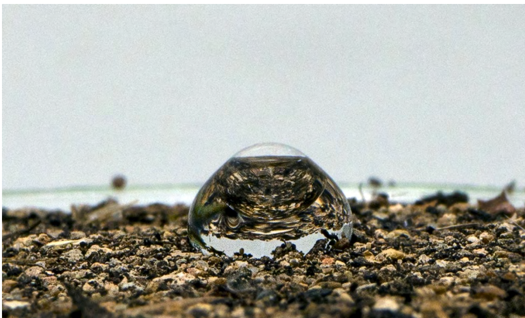
Figura 19. Un tiempo de penetración largo corresponde a una elevado grado de repelencia al agua o hidrofobicidad.
