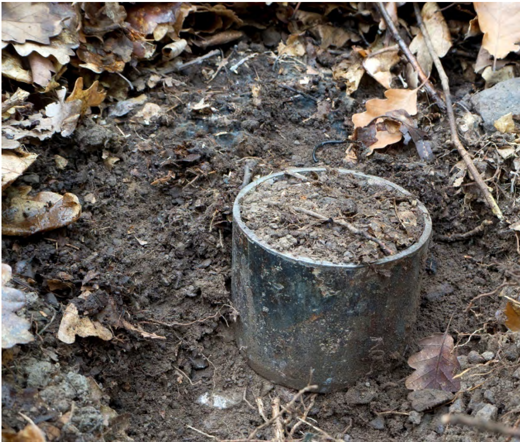
Figura 9. Una vez clavado el cilindro en el suelo, debe excavarse a su alrededor para su extracción evitando que la muestra se caiga por la parte inferior del cilindro.
