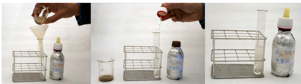
Figura 15. Una vez filtrado el extracto del suelo (izquierda), se le añaden unas gotas de la disolución de AgSO 4 4,4 g l -1 , que desencadena la formación y precipitación de AgCl 2 , apreciable por la aparición de turbidez blanquecina.
