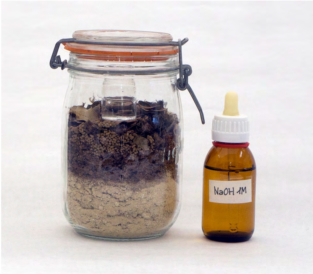
Figura 16. En el tarro se ha reproducido la secuencia de horizontes que forman un suelo, y se ha incubado cerrado herméticamente durante dos días con un vasito en la superficie que contiene 10 ml de NaOH (en este caso, 1M).
