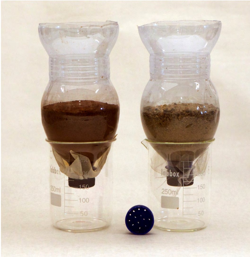
Figura 21. Columnas de percolación preparadas y listas para su uso. En la parte central se aprecia el tapón con los agujeros para facilitar la evacuación del agua. En este caso, la columna de la izquierda contiene un suelo arcilloso y el de la derecha un suelo arenoso.
