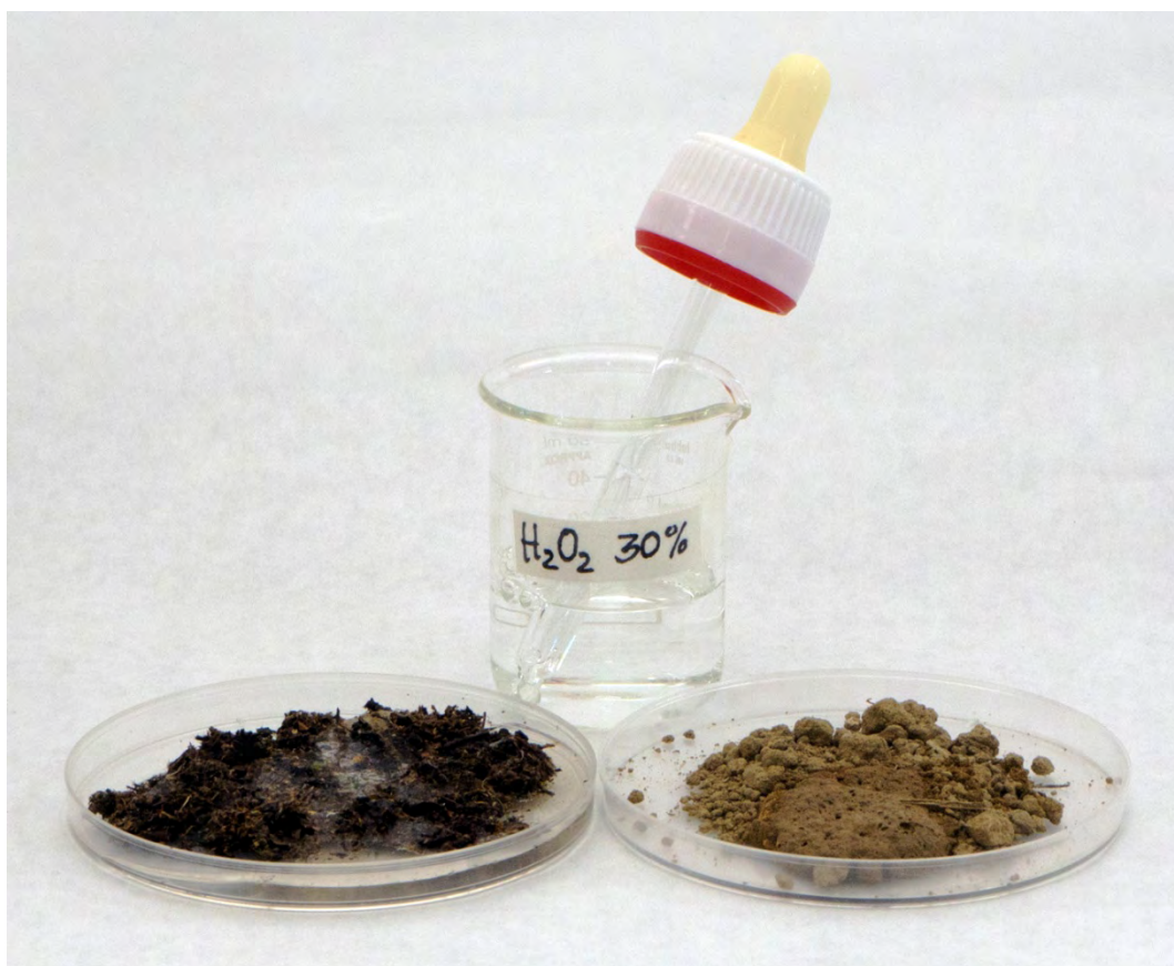
Figura 11. La reacción del suelo de la derecha a la adición de H_2O_2 ha sido muy escasa, y solamente se aprecia alguna cavidad causada por un burbujeo muy reducido. Por el contrario, la muestra de la izquierda, mucho más orgánica, ofrece una reacción con una efervescencia blanquecina mucho más visible.
