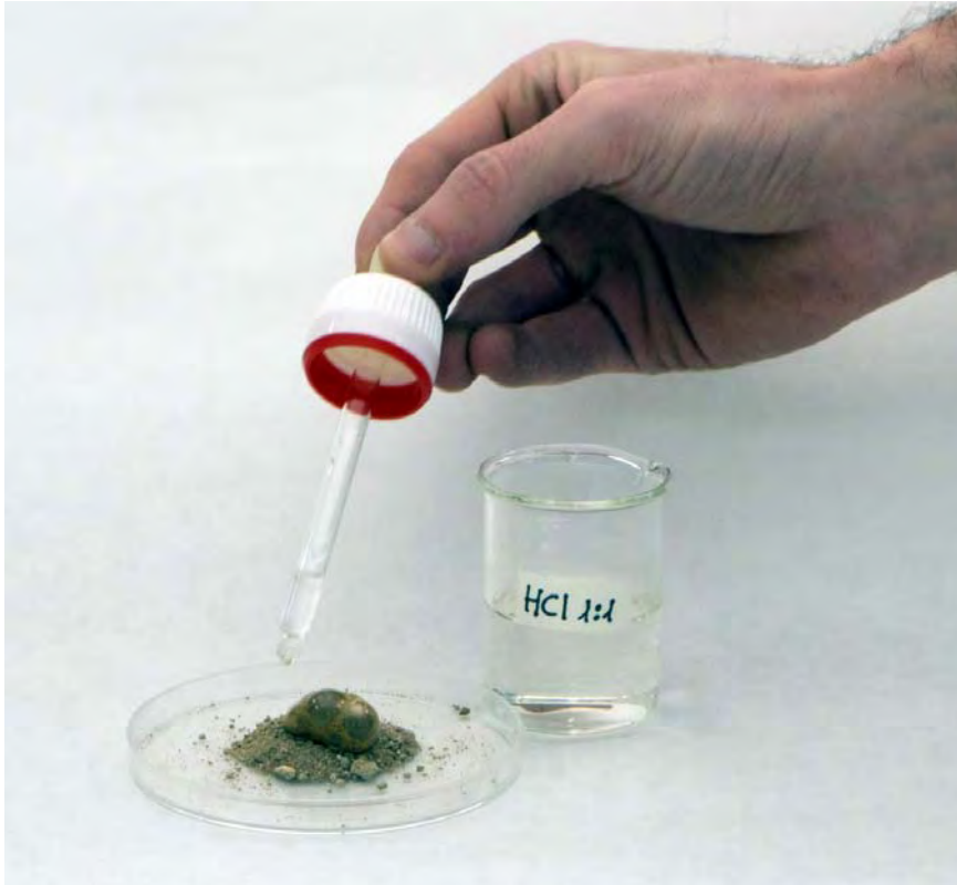
Figura 13. Cuando el suelo contiene \text{CaCO}_3 , la adición de HCl 10% ó 1:1 origina una reacción de efervescencia causada por la transformación del carbonato en \text{CO}_2 .
