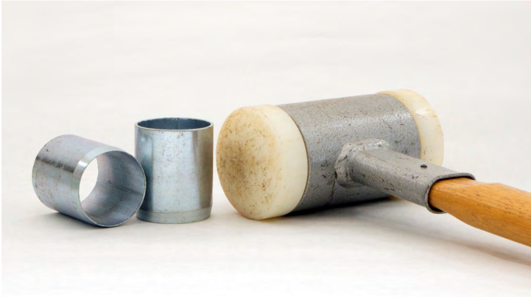
Figura 8. Cilindros metálicos y martillo para la extracción de muestras inalteradas de suelo que utilizan los profesionales.
