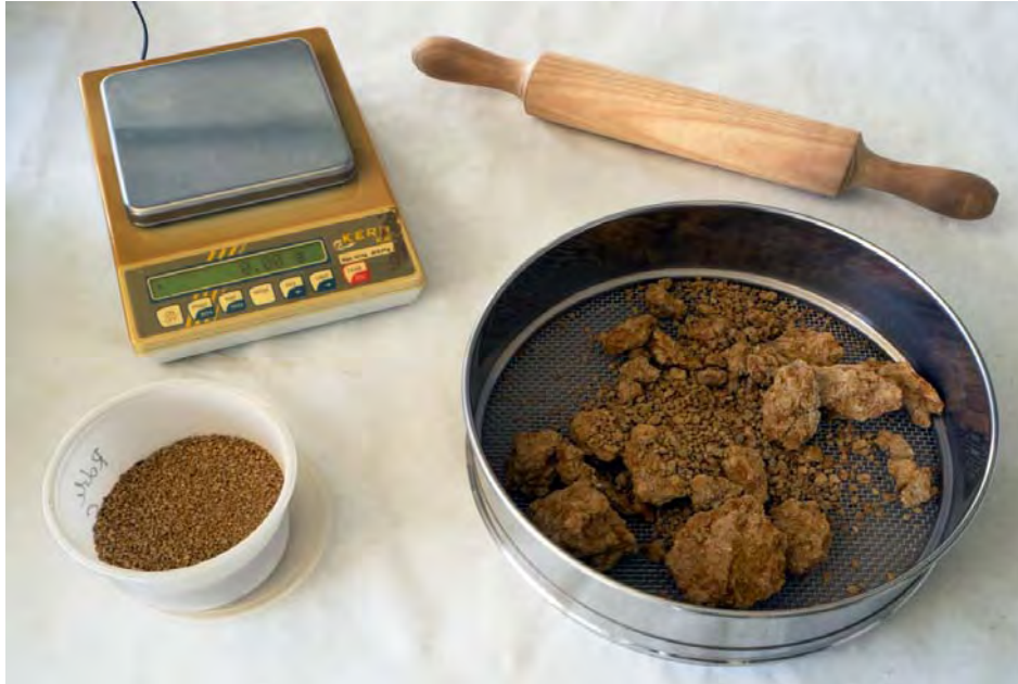
Figura 3. Tamiz de 2 mm de luz, rodillo de madera y balanza, útiles usados habitualmente para calcular el porcentaje de tierra fina de las muestras.
