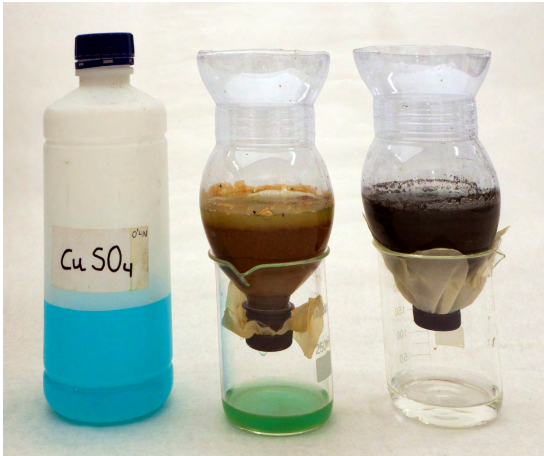
Figura 12. El suelo de la derecha, arcilloso y con mucha materia orgánica, ha retenido el cobre de la disolución. Por el contrario, en el de la izquierda, arenoso y más pobre en materia orgánica, la disolución ha filtrado prácticamente sin retención y su color azulado se ha mezclado con el amarillo de la materia orgánica y el óxido de hierro, dando un color verdoso.
