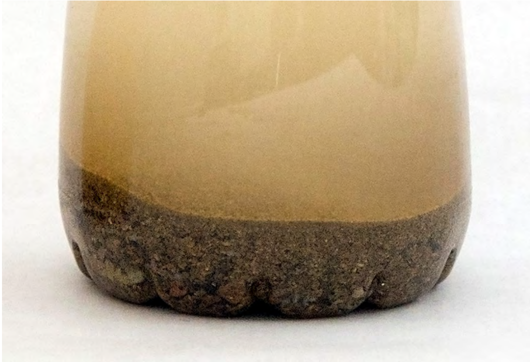
Figura 6. Cuando se deja sedimentar la muestra de suelo en suspensión, las partículas de mayor tamaño lo hacen en primer lugar, localizándose en la parte inferior de la botella.
