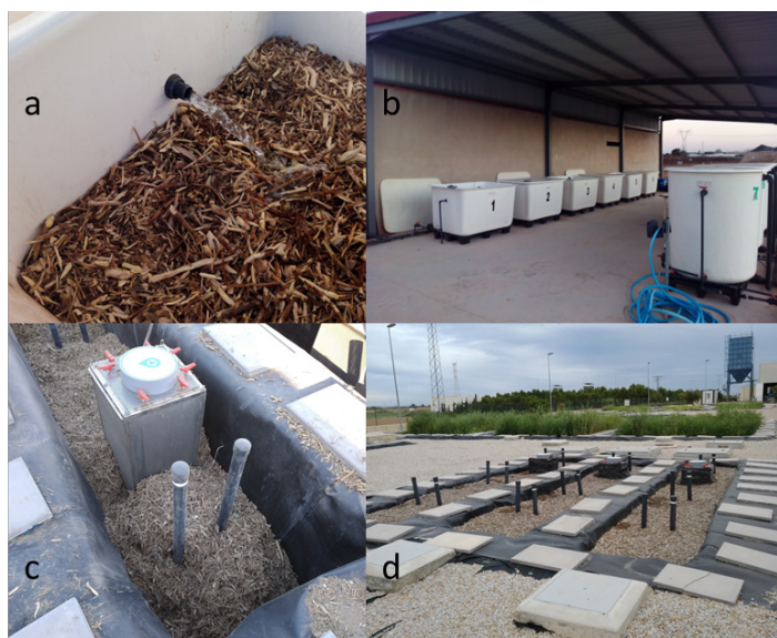
a y b) Planta piloto con biorreactores de astillas para la desnitrificación de salmueras; c y d) Planta piloto con biorreactores de astillas (en primer término) y humedales (al fondo) para el tratamiento de lixiviados agrícolas.
