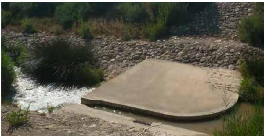
*Aforador para medir el caudal de salida de la cuenca. También hay un muestreador automático instalado y en las muestras se analiza CE, nitratos y fosfatos de manera rutinaria y plaguicidas*
