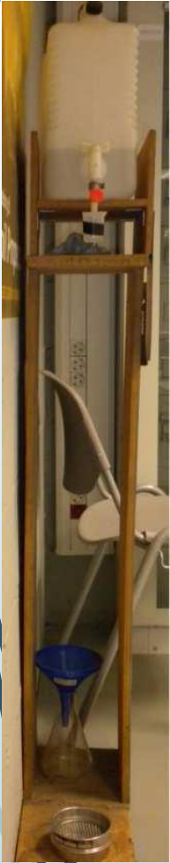
Estabilidad de Agregados (AS) utilizando TDI
